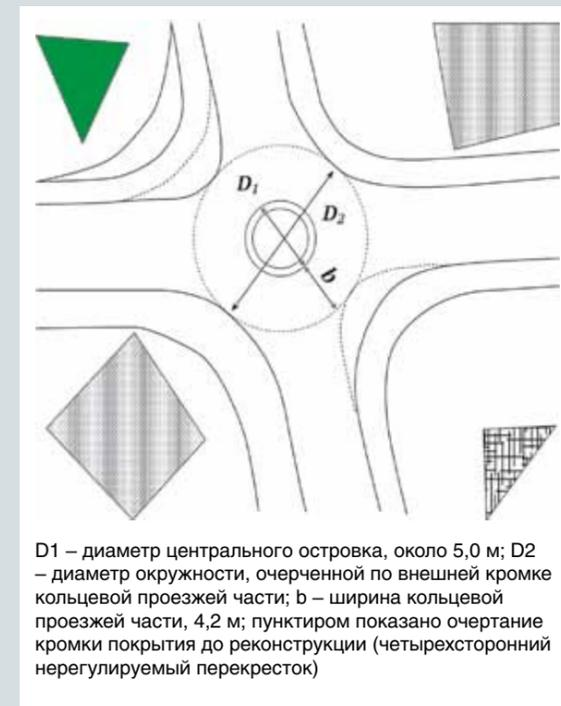
Рис. 7. Схема мини-кольцевого пересечения при реконструкции в плотной существующей застройке населенного пункта
