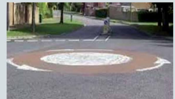
Рис. 10. Центральный островок мини-кольцевого пересечения, выделенный разметкой
