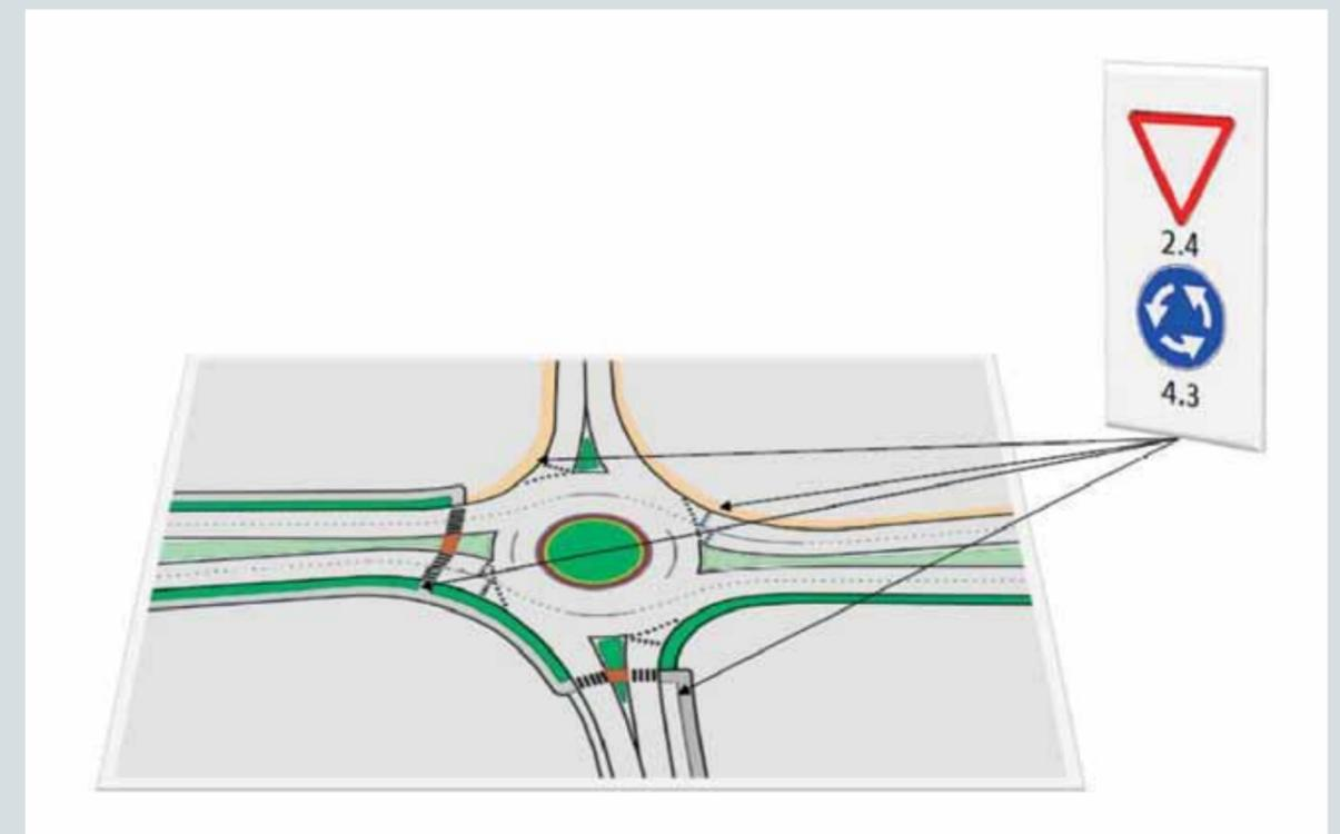
Рис. 13. Схема установки знака 4.3 в сочетании со знаком 2.4 на кольцевом пересечении
